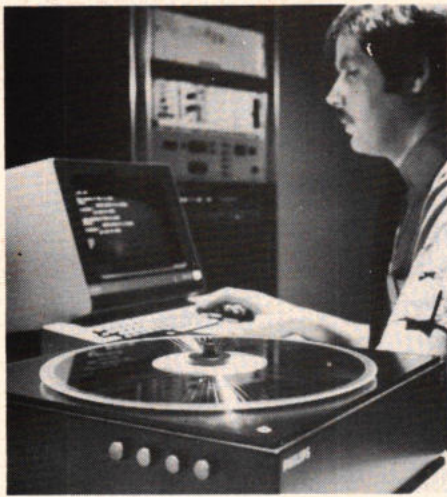
Afb. 6. Philips' zeer compact optisch systeem voor gegevensvastlegging waarin een diode laser wordt toegepast.
