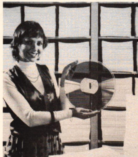
Afb. 5. Bij het optisch registratiesysteem wordt een dubbelzijdige plaat van 30 cm diameter toegepast. Daarop kan het equivalent van 500 000 getypte bladzijden worden vastgelegd. Elke regel van elke willekeurige „bladzij” wordt in minder dan een halve seconde teruggevonden.
